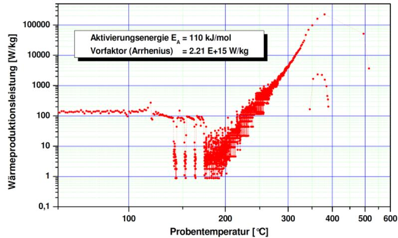
Abbildung 4: Wärmeproduktionsleistung (abgeleitet aus Temperatur-Zeit-Verlauf)
