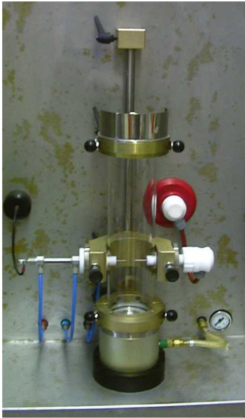
Abbildung 1a (links): Mindest-Zündenergiebestimmung in der Mike-3-Apparatur Abbildung 1b (rechts): Temperaturabhängigkeit der Mindestzündenergie (von verschiedenen Substanzen)
