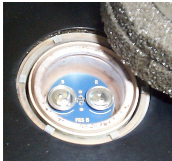
**Abbildung 2:** Ofen eines DSC-Geräts: links Tiegel mit der Probe (S, sample), rechts Referenztiegel (R)
