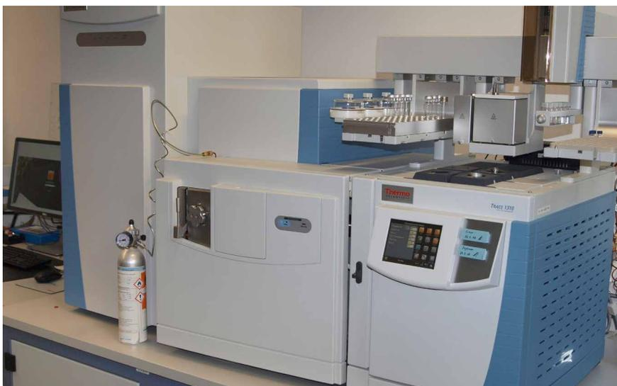
Abbildung 1: Q Exactive GC Orbitrap GC-MS im Massenspektrometrie-Labor in Hanau: Gaschromatograph, Quadrupol-MS, Orbitrap-Analysator (von rechts nach links)
