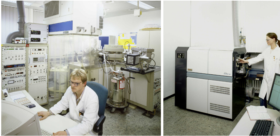
Abb. 2: vorhandene GDMS-Geräte: VG 9000 von VG Elemental (für spezielle Fragestellungen, links) und das neuere Gerät Element GD von Thermo Fisher Scientific (für Routinemessungen, rechts).
