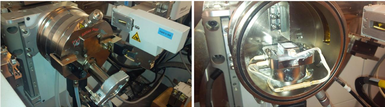
Abbildung 3: Röntgenpulverdiffraktometer X'Pert MPD Pro mit angebauter Niedrigtemperaturkammer: geschlossen (links) und Blick hinein mit Probenträger und Probenmaterial (rechts).
